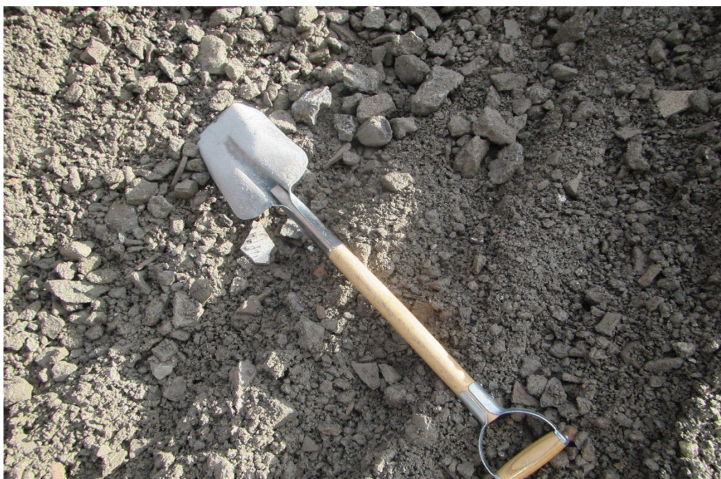
Foto 2: Detailaufnahme der recycelten Gesteinskörnung
