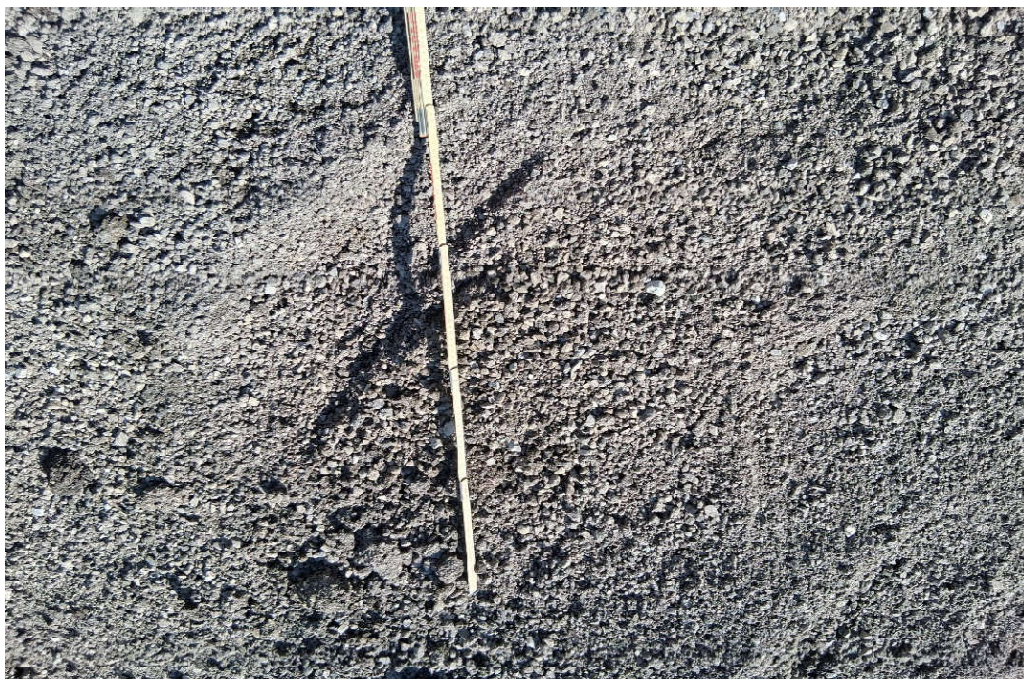
Foto 2: Detailaufnahme der recycelten Gesteinskörnung
